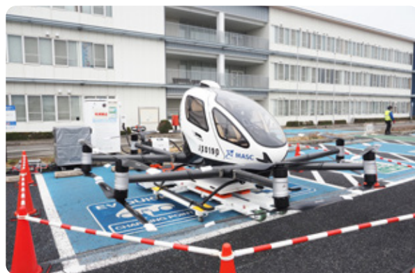
試験飛行前に電力供給を受ける「EH216」(淡路市役所)
