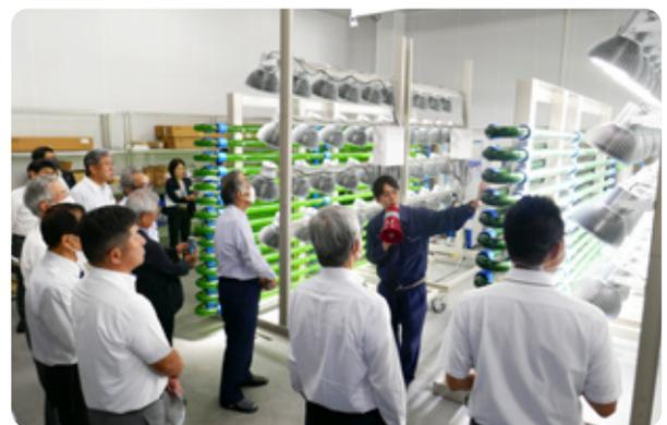
微細藻類を培養するチューブ型の研究設備
