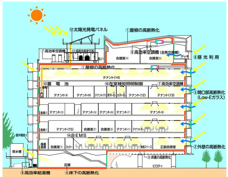
よる室温変化を予測して空調能力を調整するなど、通常のエアコンより高い効率を実現します。
