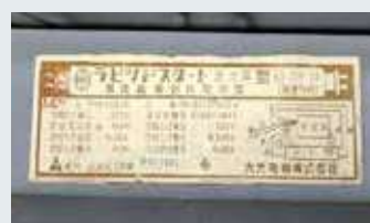
撤去した高濃度PCB混入安定器
